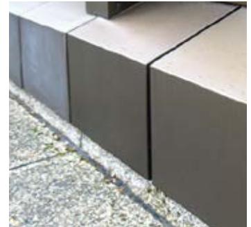
GEREINIGTE MUSTERFLÄCHE (ELOXAL) MIT KONSERVIERUNG NACH 4 WOCHEN BEWITTERUNG
